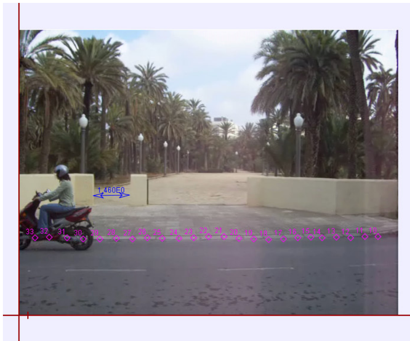
Figura 1: Reproducció d'un moviment rectilini uniforme (MRU) i marca de cada fotograma indicant-hi la posició d'un element mòbil.
