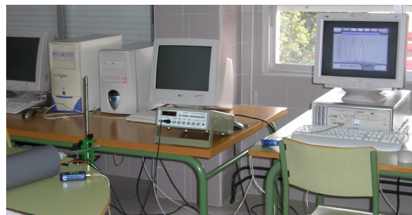
Fig 4. Muntatge complet, amb generador d'ones i ordinador (veure l'apartat anterior).
