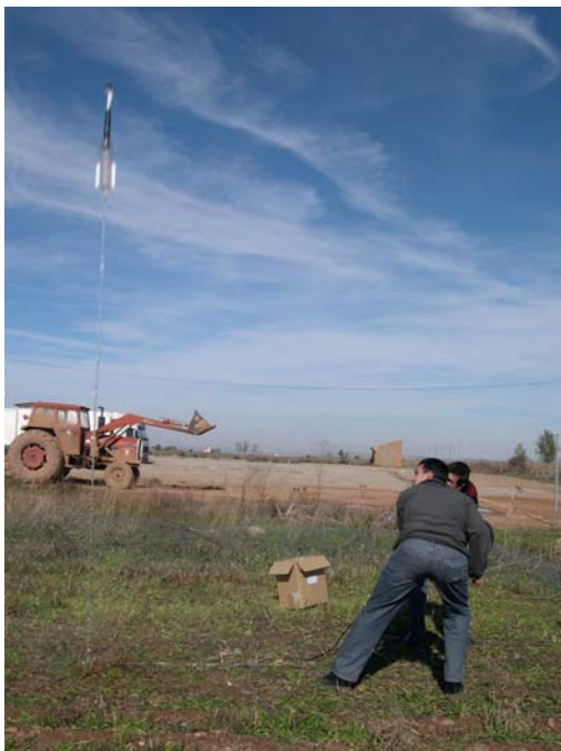
Cohete propulsado por agua y aire comprimido. Alcanza una altura de hasta 40 m.
