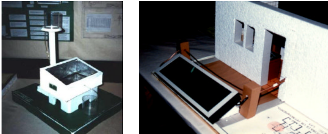
Figuras 3: Modelos demostrativos realizados por alumnos de la Electiva Arquitectura Bioclimática Destilador Solar (Izquierda) y Calentador Solar de Agua para balcón de vivienda en altura (Derecha)
